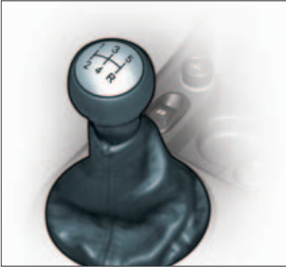
Versnellingspook van de handgeschakelde versnellingsbak
